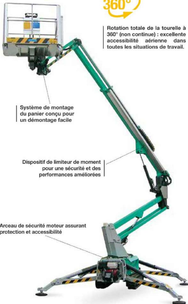
Système de montage du panier conçu pour un démontage facile
