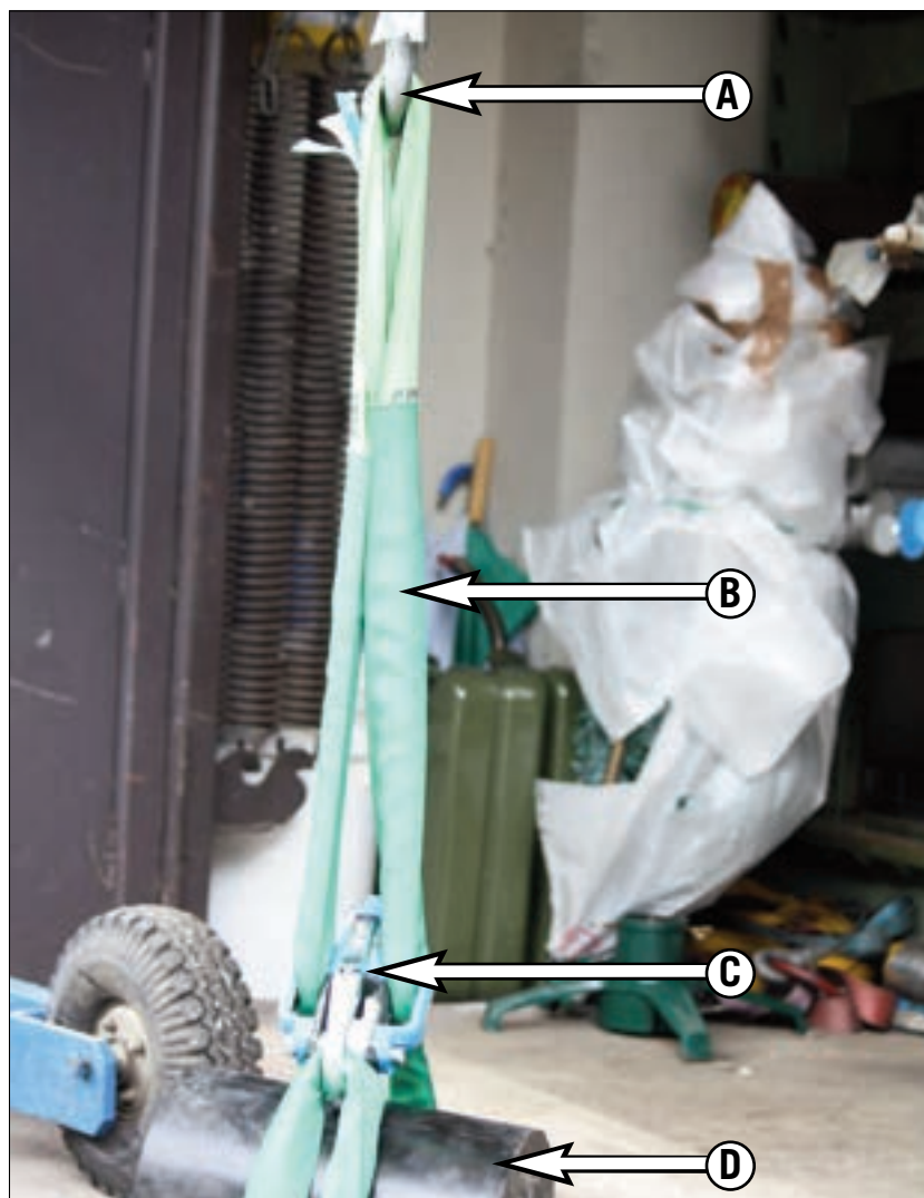
Mode d'attache : « Traction par manille/alésage »
